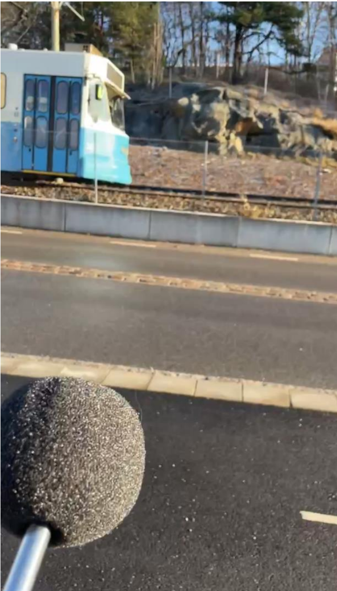
Figur 2 Visar spårvagn av modell M31 som färdas i södergående riktning tillsammans med mätutrustning av fabrikat Svantek.
